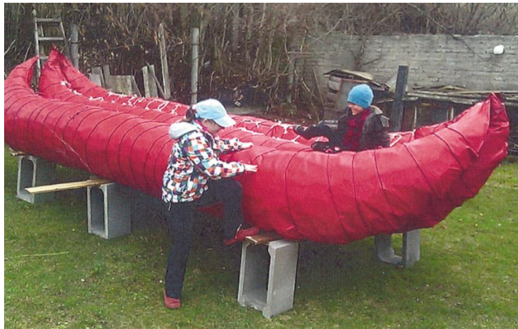
Jaro 2013 – Rackové společně s dospěláky dokončují vlastní loď. Uvnitř tubusu je spousta prázdných PET láhví.
